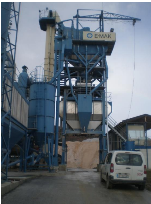
Слика- асфалтна база со елементи мешање, мерење, дозирање
