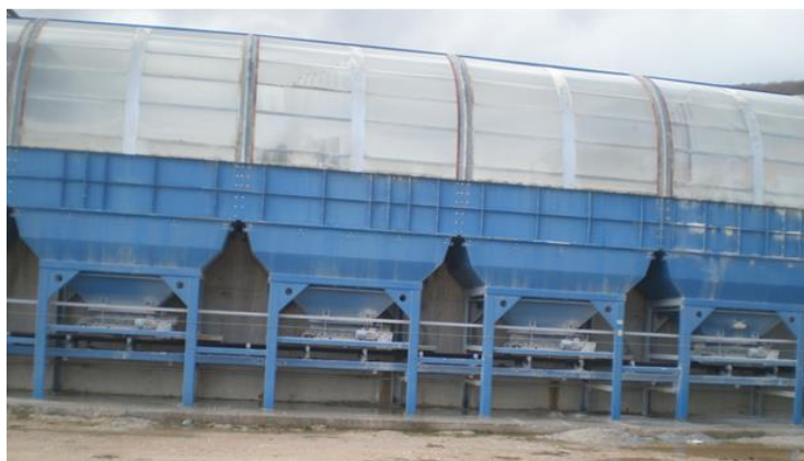
Слика- силоси за дозирање на суровина
