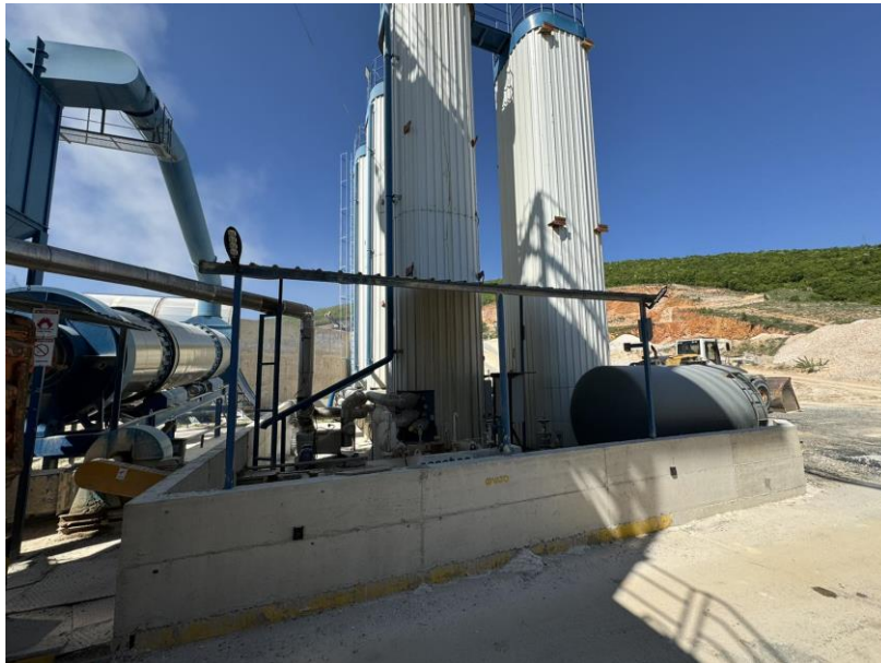
Слика- Силоси за битумен
