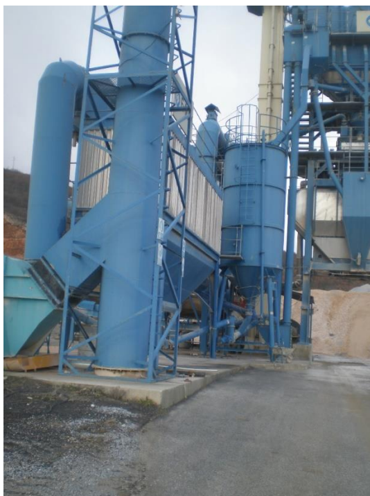
Слика- систем за отпрашување (филтер со вреќи)
